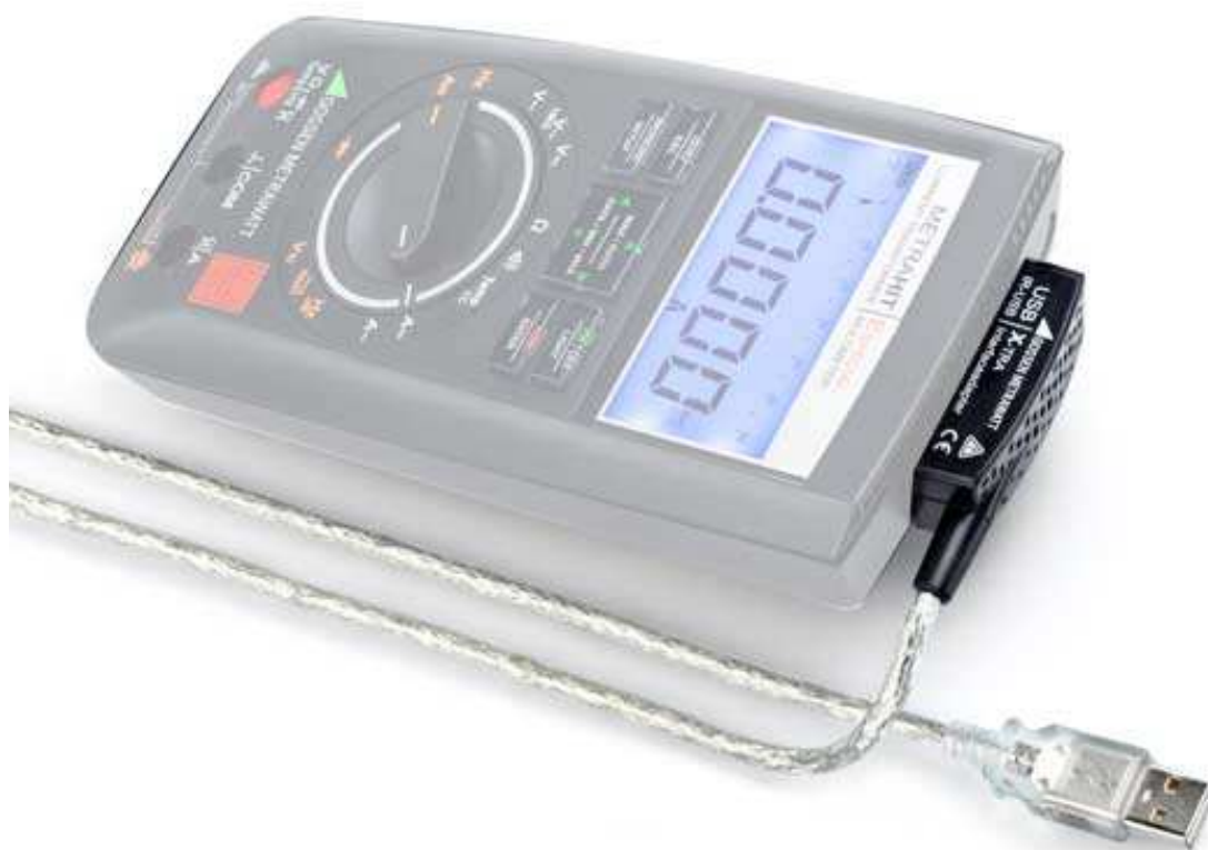
Obrázek 2: Interface adaptér připojený k multimetru [3]
