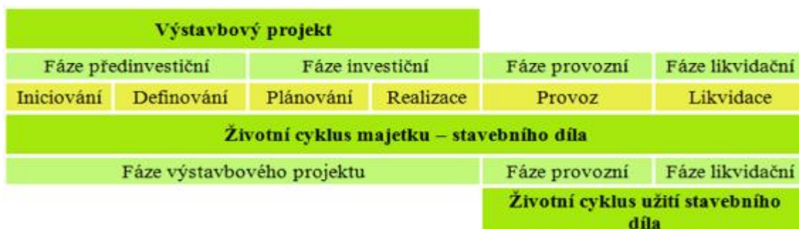
Obrázek 1 - Fáze životní cyklu stavby a stavebního díla [9]
