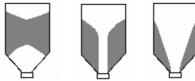
Obr. 4: Klenba, střední tunel a netekoucí materiál na stěnách
