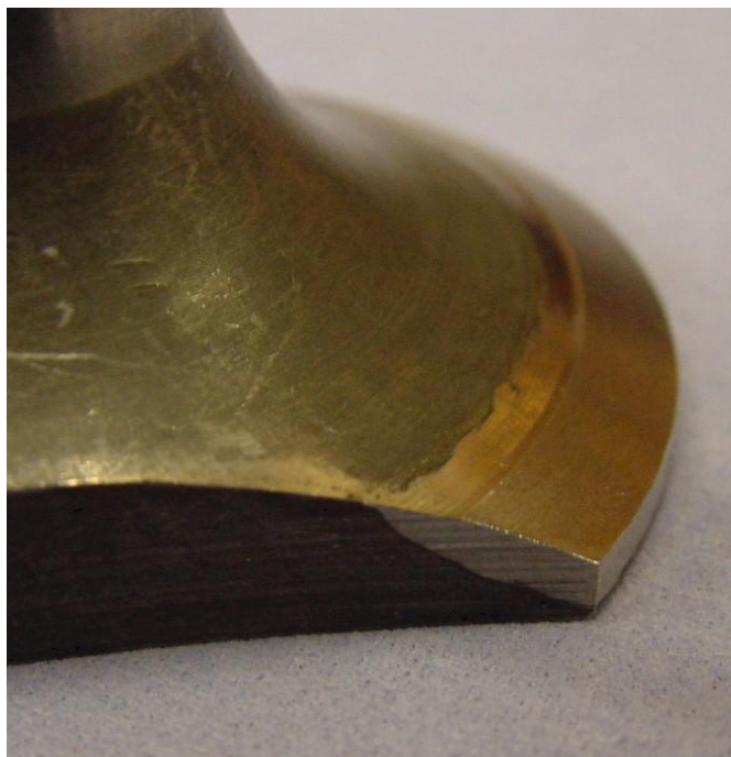
Obr. 9: Pancéřování ventilu materiálem Stellite F® [18]
