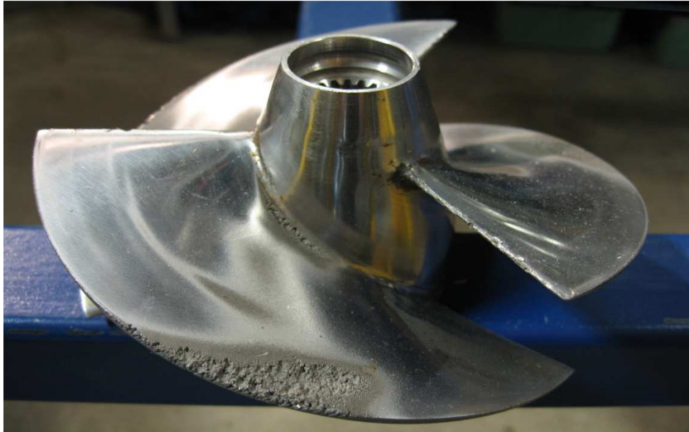
[obrázek 3] : Kavitace na lodním šroubu
