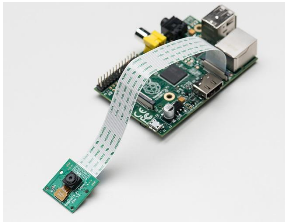
Obr. 6 Kamera připojená k Raspberry Pi [18].
