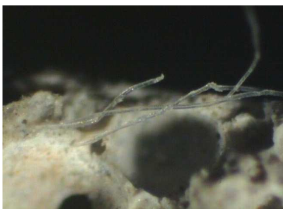
Obr. č. 3: Fotodokumentace z optického mikroskopu – vlákna po 100 °C bez poškození
