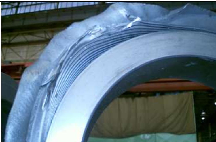
Obr. 6 - Vzhled lomové plochy na odtržené části válcové nádoby HPA i s vnitřní prstencovou maticí (foto znalec)
