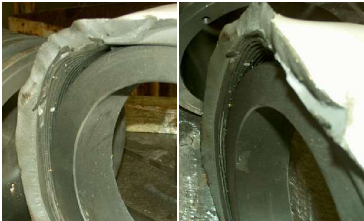
Obr. 4 a 5 – Vzhled lomové plochy na odtržené části válcové nádoby HPA i s vnitřní prstencovou maticí (foto znalec)
