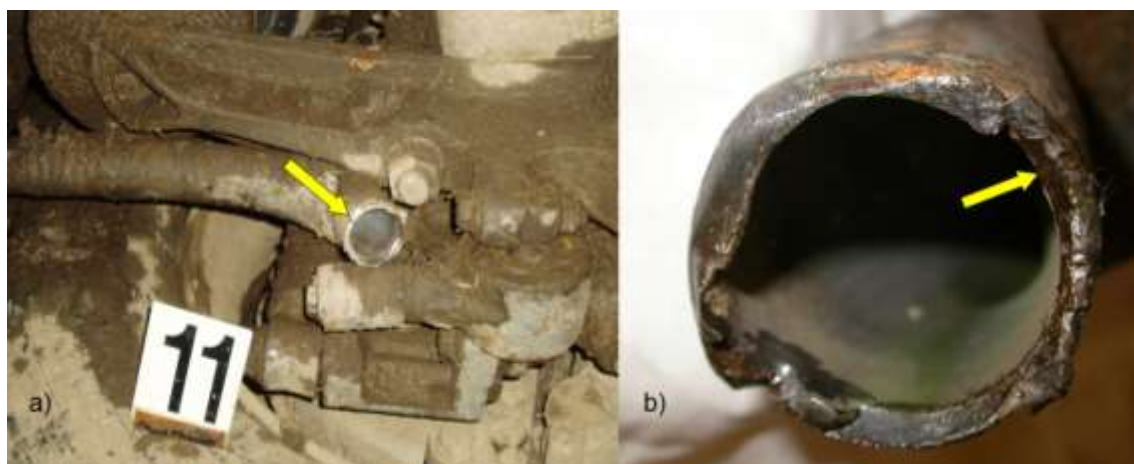
Obr. 17 – Stav poškozeného dílu nápravy po dopravní nehodě (a) a stav při prohlídce (b) Fig. 17 – A state of the damaged part of the axle of a car after a car accident (a) and its state during the examination (b)
