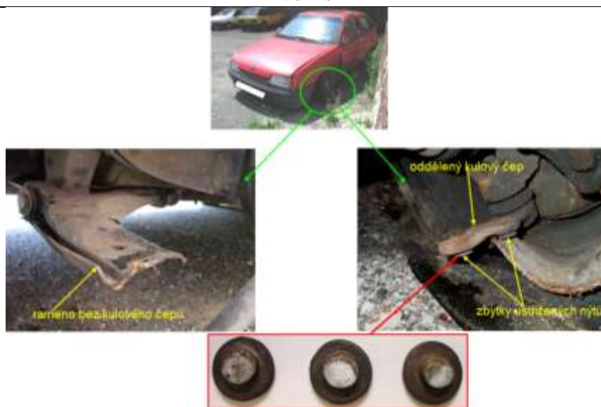
Obr. 10 – Uplatňování technické závady- porucha nýtů Fig. 10 – Technical defect application - rivets defect
