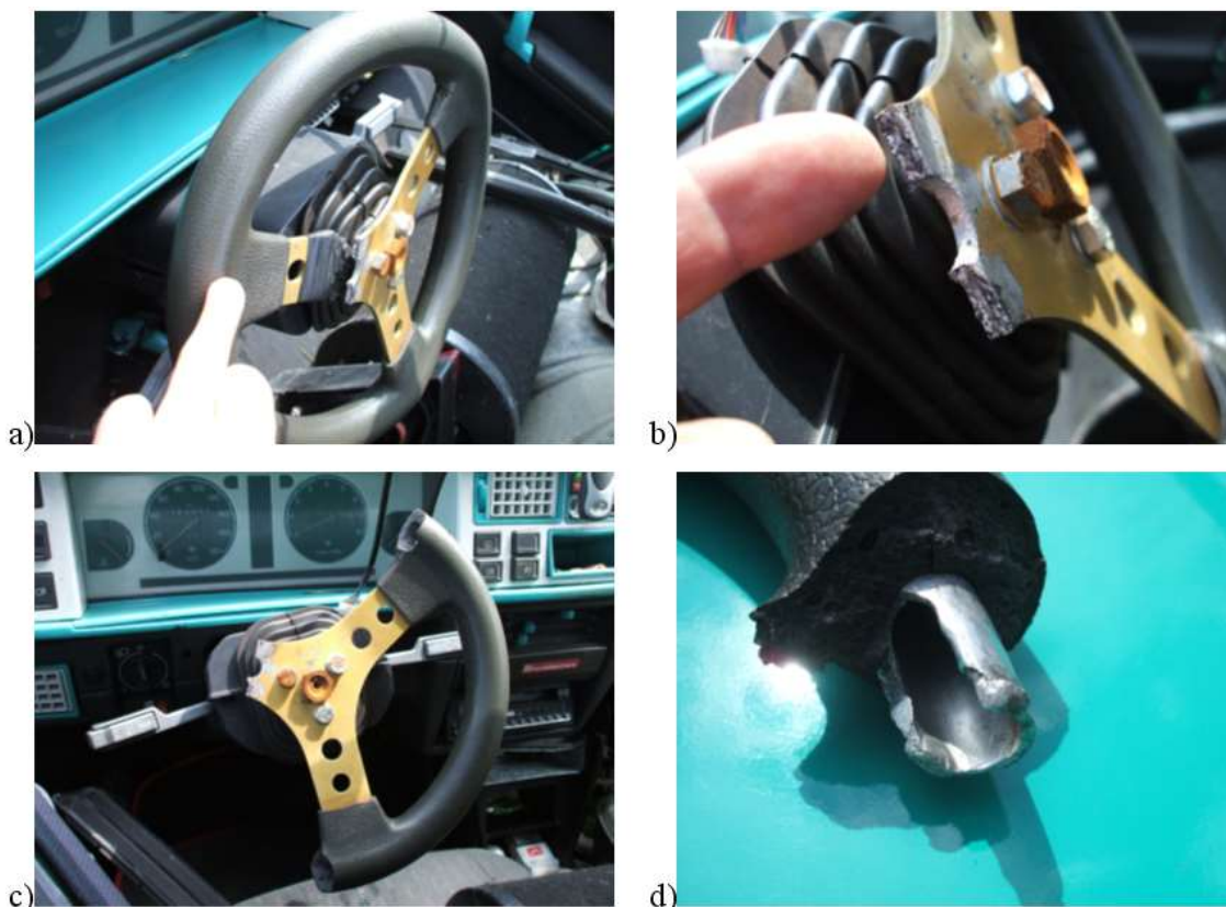
Obr. 11 – Uplatňování technické závady- porucha volantu Fig. 11 – Technical defect application - steering wheel defect
