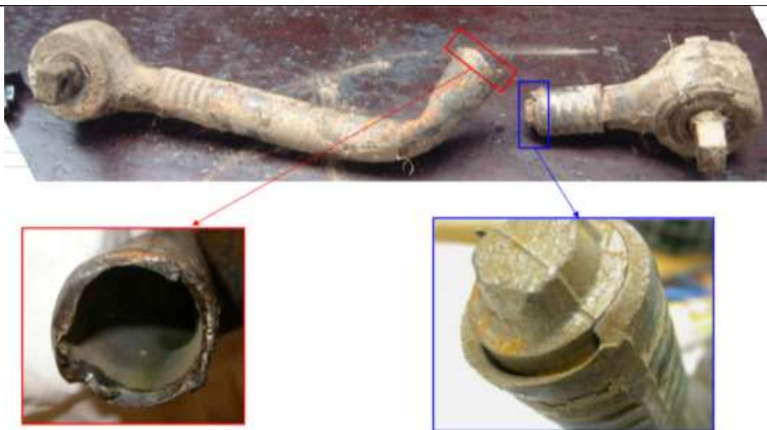
Obr. 9 – Uplatňování technické závady- porucha vzpěry
