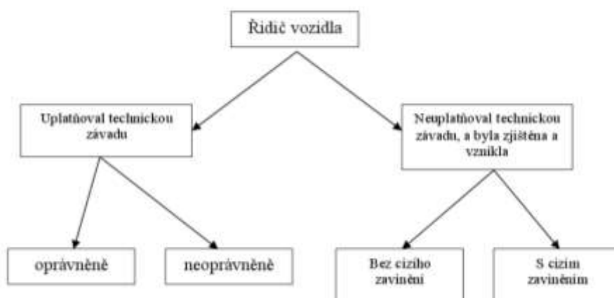
Obr. 1 – Členění technických závad jako příčin vzniku havárie ve vztahu k řidiči Fig. 1 – Technical defect classification as the cause of car accidents in relation to a driver
