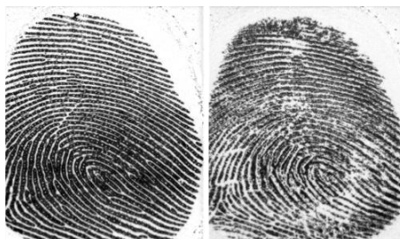
Obrázek 2: Pravý otisk prstu vlevo, falešný otisk prstu (silikon) vpravo.
