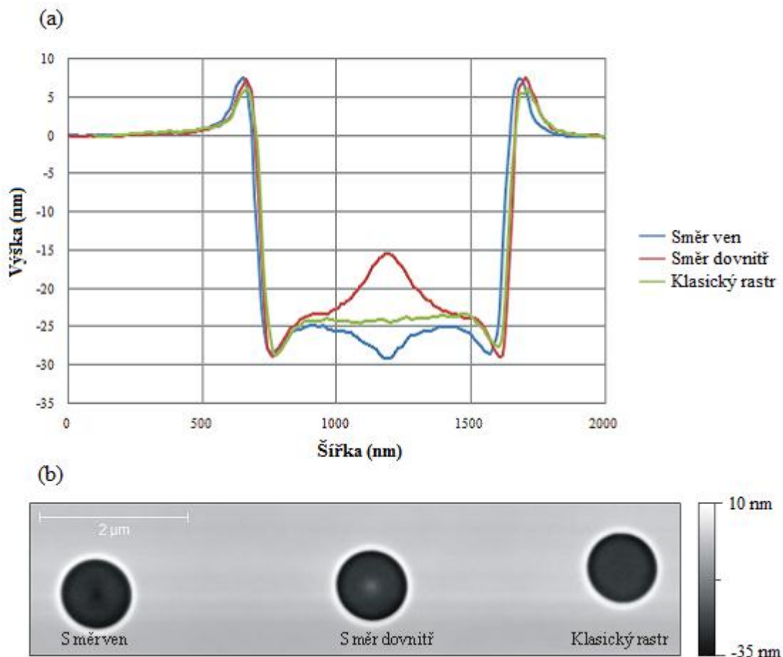
Obr. 14. (a) Profil struktury kruhového průřezu pro dobu prodlevy 1 \mu s pro různé rastrovací strategie. (b) Obraz vytvořených struktur změřený mikroskopem AFM.
