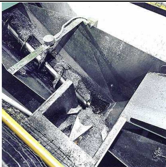
Obr.18 Kombinace dopravy třísek harpunovitým a šnekovým dopravníkem [12]
