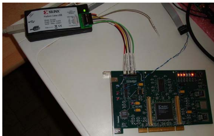
Obr. č. 26. Programovanie obvodu FPGA prostredníctvom rozhrania JTAG
