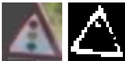
Obrázek 4.5: Ukázka špatně odstraněného pozadí a špatně vytvořené binární mapy
