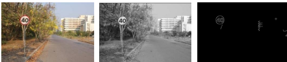
Obrázek 2.4: Vlevo: zdrojový obraz, uprostřed: obraz ve stupních šedi, napravo: po použití Canny hranového detektoru
