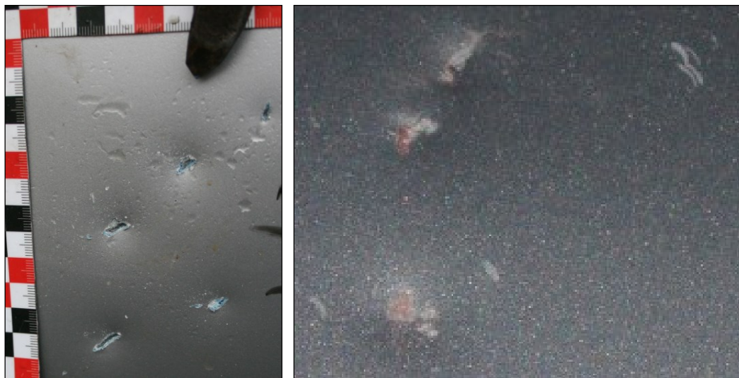
Obr. 5: Příklad porovnání záměrně vytvořeného poškození při zkouškách – sekáč (vlevo) s deklarovaným poškozením po dopravní nehodě (vpravo)
