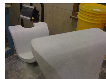
Obr. 5: Příklad odlitků z kompozitu Ductal. Zdroj: amphorae.wordpress.com
