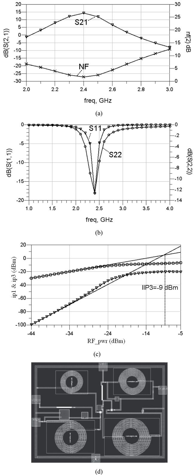
Fig. 5. Simulation results of the LNA. (a) S21 and NF. (b) S11 and S22. (c) IIP3. (d) The layout of the LNA.
