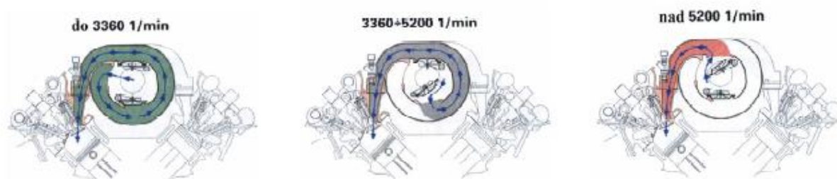
Obr. 5 Trojstupňový systém se zapínatelným sacím potrubím [1]
