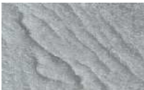
Obr.2.9 Příliš vyleptaná plocha [16]
