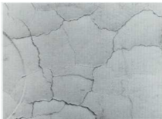
Obr.2.12 Popraskání skořepiny při sušení [16]
