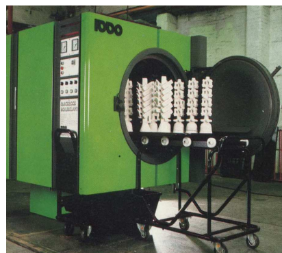
Obr. 2.5 Vytavovací zařízení Boilerclave [13]
