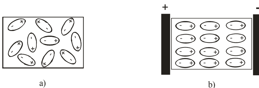
Obr. 2: a) Molekuly polárního dielektrika (mimo elektrické pole). b) Polární dielektrikum v elektrickém poli
