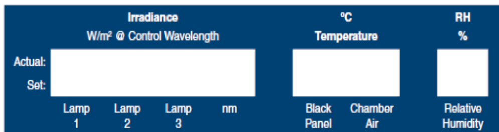
Obr. 2.5: Displej zobrazující vln. délku záření, teplotu černého panelu a relativní vlhkost Zdroj: [15]
