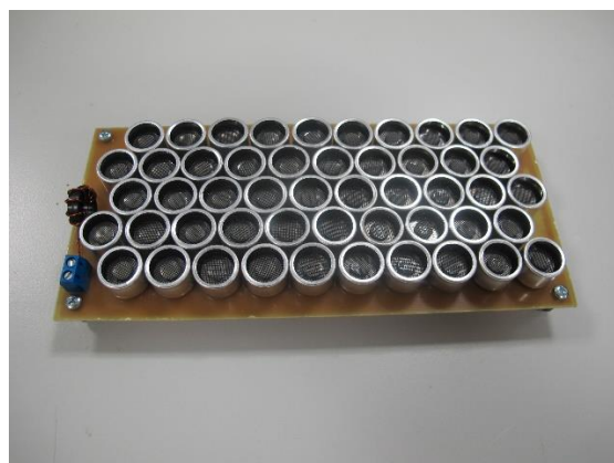
Obrázek 2: Vyzařovací charakteristika (vlevo) a fyzická realizace parametrického reproduktoru (vpravo)
