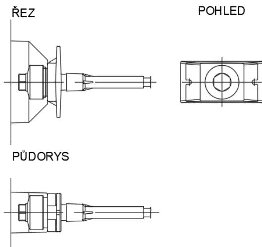
V základové desce bylo využito kotev firmy VSL typ S6-4.
