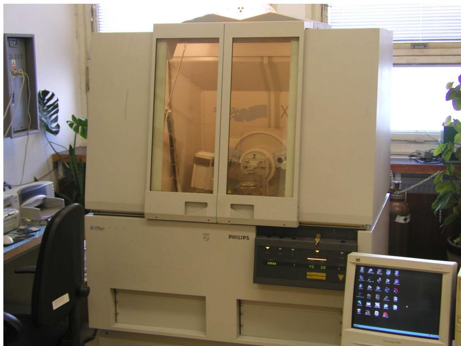
**Obr. 17.** RTG difraktometr Philips X'Pert
