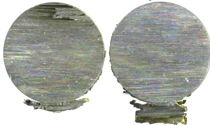
Abb. 5.14 Schnittflächen des Kreiselschnitts
