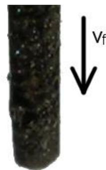
Abb. 5.7 ungleichmäßiger Schleifscheibenverschleiß
