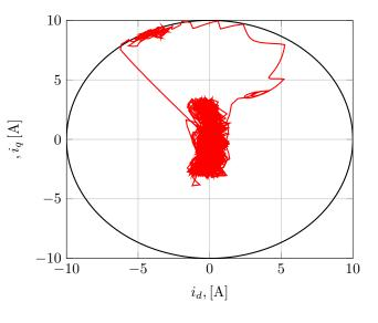
Fig. 4. Current in dq reference frame
