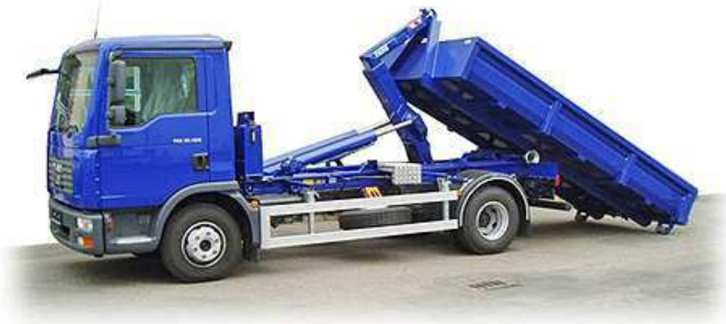
Obrázek 26 - kontejnerové vozidlo MAN TGL 12.180 BB 2x4 [12]
