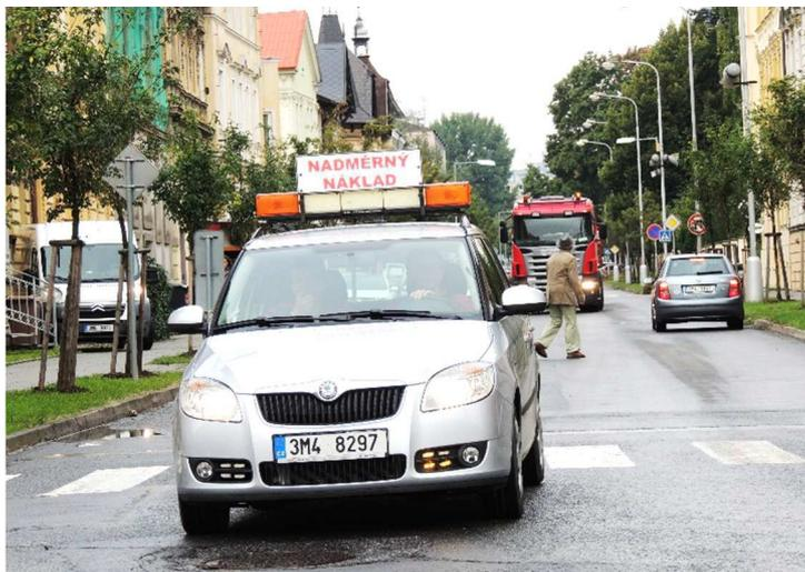
Obrázek 3 – Doprovodné vozidlo [3]
