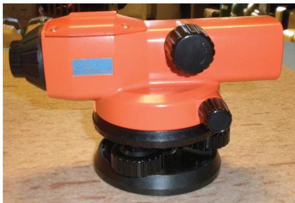
Obr. č. 6 - nivelační přístroj Sokkia C41
