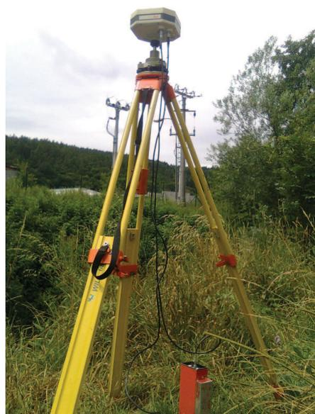
Obr. č. 6 - aparatura GPS
